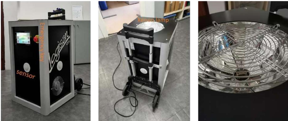
Figura 1 – Logisan 1000; Alimentazione del dispositivo 300 W; potenza luce: 250W.
